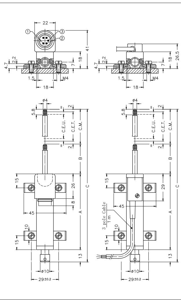
重要提示：产品说明书中包括线性度、使用寿命、温度系数在内的所有数据均为传感器正常使用参数，游标允许通过的最大电流不得超过0.1微安。
