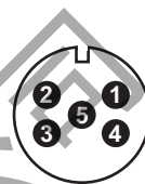
5 针 M12 插座 (望向传感器头插座方向)
